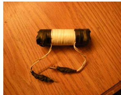
Funktion: Jumper offen: 20m, zu: 30m, statt Kurzschluss Spule einschleifen: 40m
